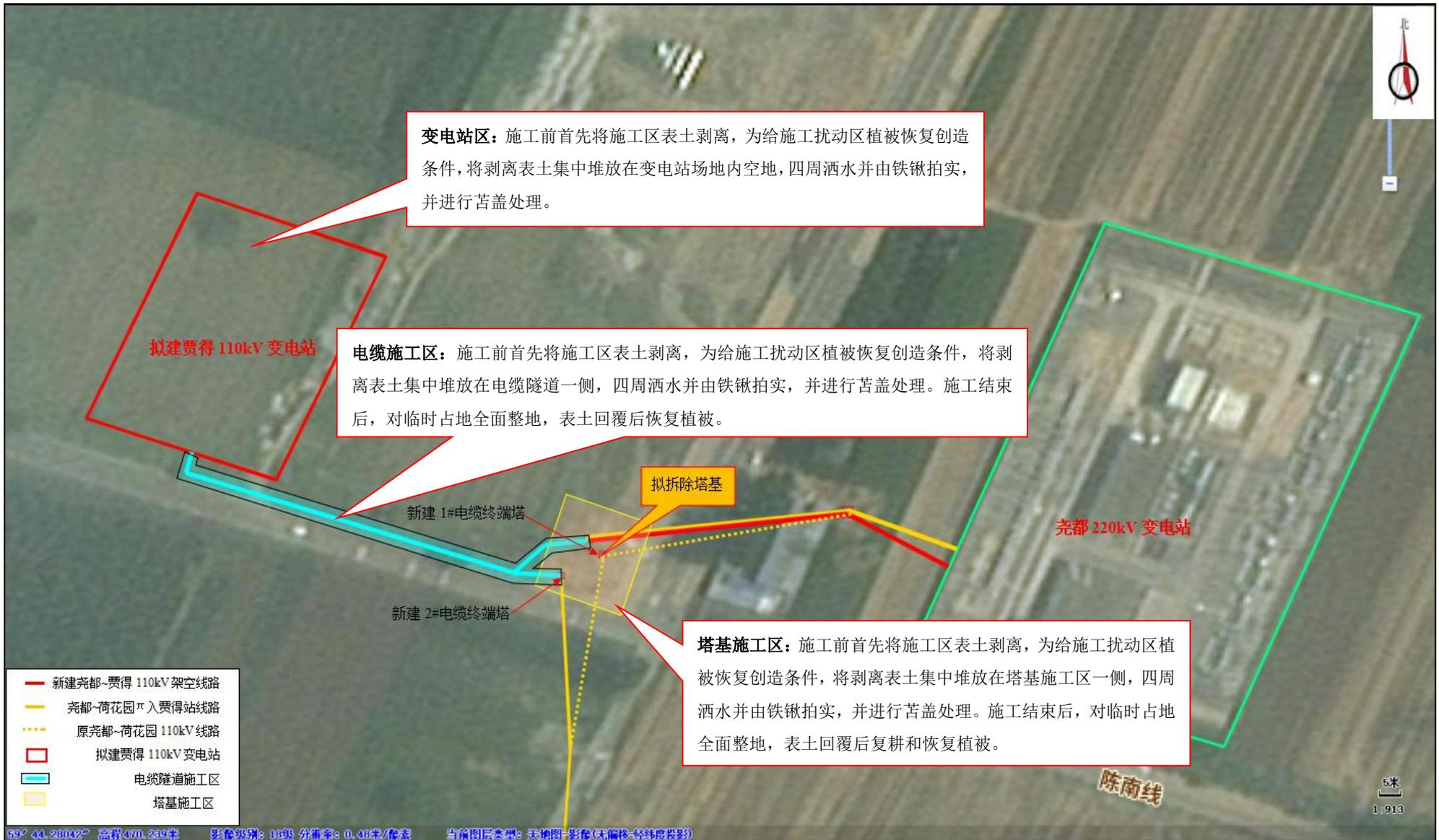
附图 13 典型生态保护措施平面布置示意图
