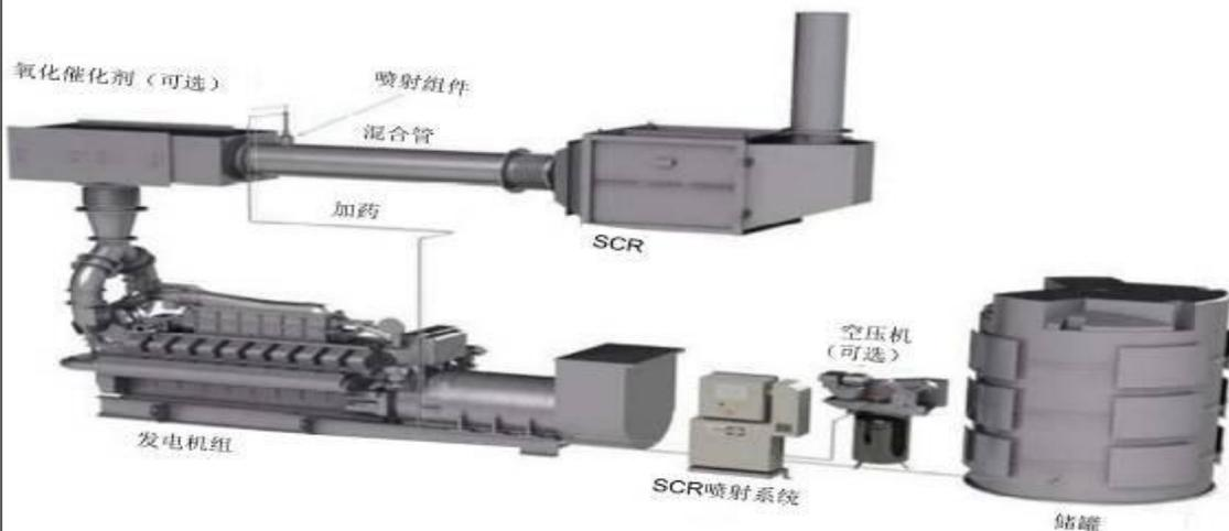
图 4-1 SCR 脱硝设备装置示意图
