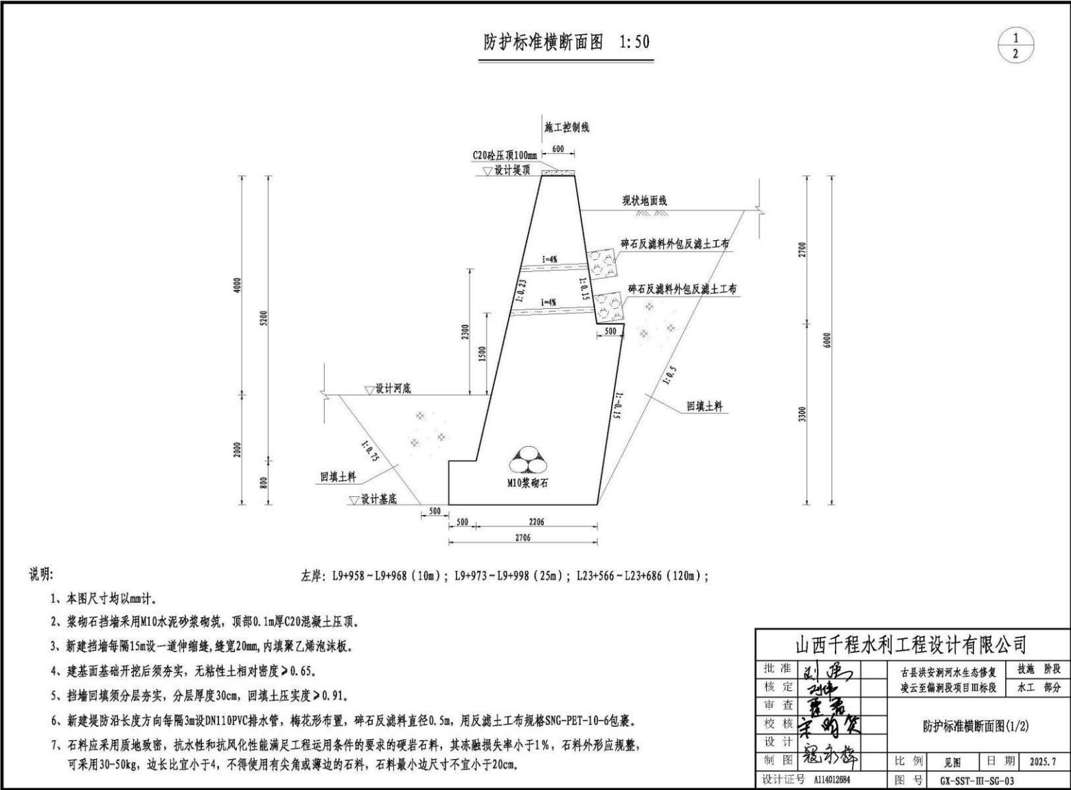
图 3.2-2 浆砌石衡重式堤防横断面图
