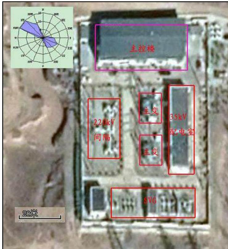
图5-1 卧羊场220kV升压站平面布置图
