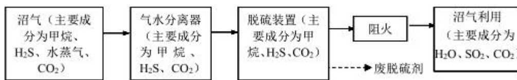
图 3.4-5 沼气净化工艺流程
