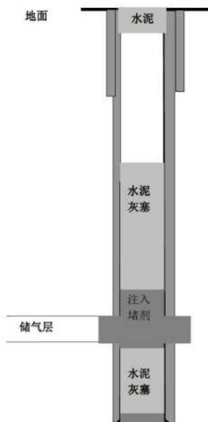
图3.2-6 封堵完井示意图
