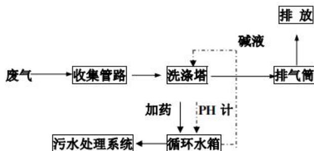
图 4-1 酸性废气治理流程图
