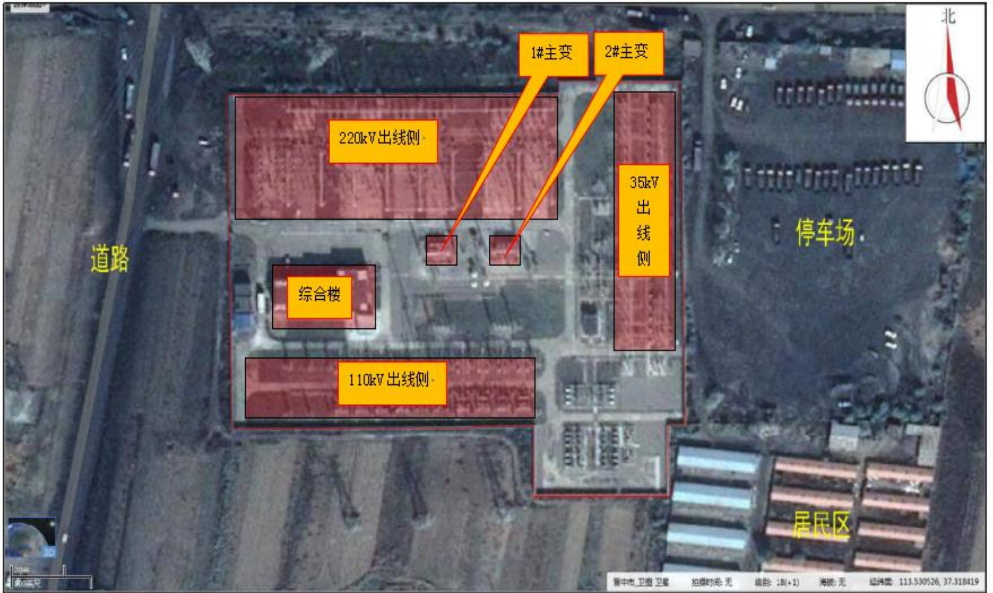
附图 6 类比变电站（云山 220kV 变电站）平面布置示意图
