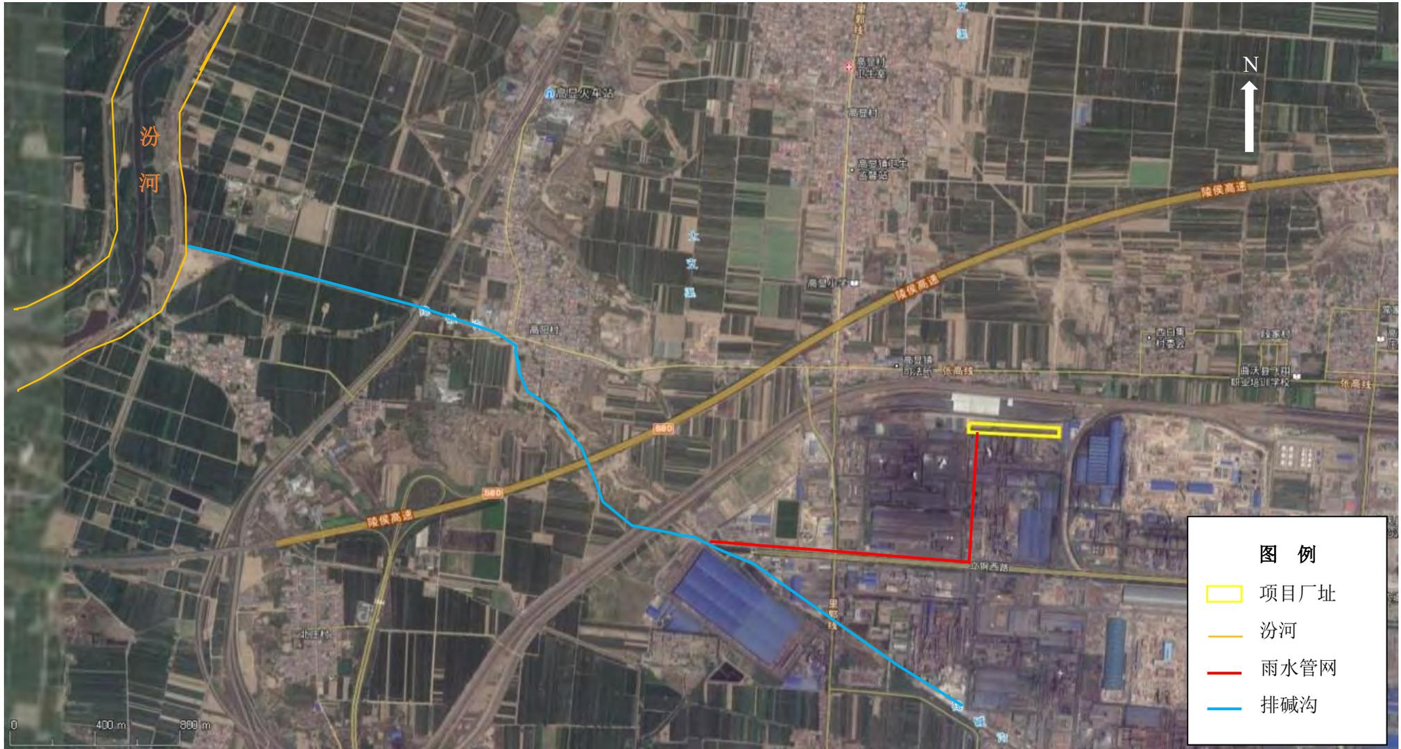
图 4.1-3 雨水流经途径图
